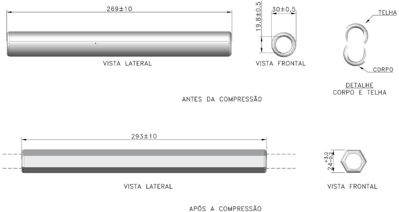
**Figura 1** - Luva de Reparo à Compressão para Cabo de Alumínio
